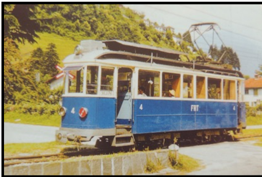
Immagine 52: La motrice Be 2/4 5 alla stazione Selva a Solduno: da questo modello le vetture erano fornite di quattro porte esterne, (foto del 1958).
